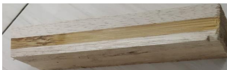
Gambar 3. Kombinasi kayu sengon (face dan back) dan bambu petung (core)
