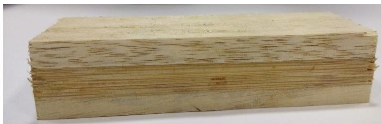
Gambar 2. Kombinasi rajumas (face dan back) dan bambu petung (core)
