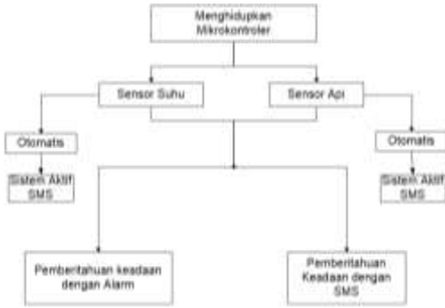
Gambar 1. Diagram Blok Sistem Mikrokontroler Keseluruhan
