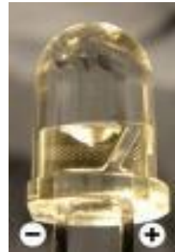
Gambar 5. Bentuk umum LED
