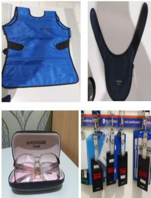
Gambar 1. Foto alat proteksi radiasi di Instalasi Radiologi RS Khusus Bedah Hasta Husada yang terdiri dari apron, thyroid shield, kaca mata Pb dan TLD ( thermoluminisence dosimeter ).
