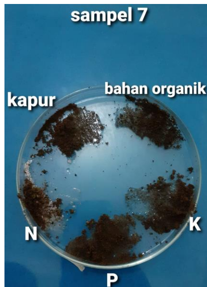
Gambar 3. Hasil Pengujian Bahan Organik dan Kandungan Kapur Tanah pada Sampel Ke – 7 Sumber: Hasil Pengamatan, 2023
