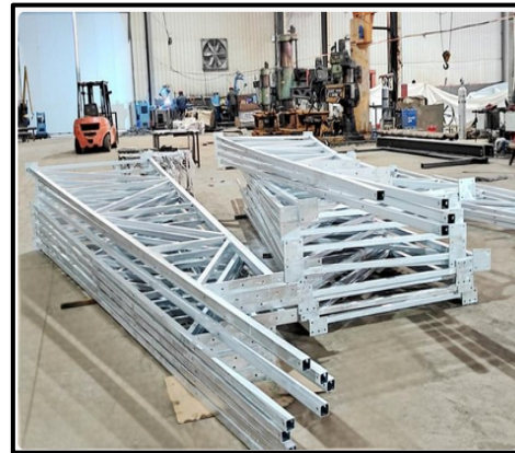
Gambar 8. (a) Proses prefabrikasi kuda-kuda baja ringan dengan mesin JIG di workshop (b) salah satu contoh hasil prefabrikasi kuda-kuda baja ringan yang siap dipasang
