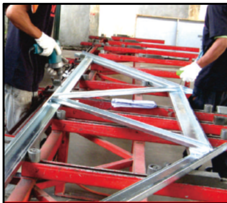
Gambar 8. (a) Proses prefabrikasi kuda-kuda baja ringan dengan mesin JIG di workshop (b) salah satu contoh hasil prefabrikasi kuda-kuda baja ringan yang siap dipasang
