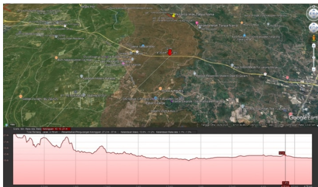
Gambar 9. Visualisasi Elevasi Jalan Tol vs Elevasi Bibir Sungai pada Kondisi Banjir Sumber: Analisis (2026)
