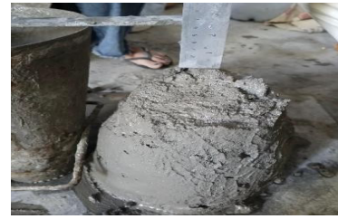
Gambar 6. Pengukuran nilai slump beton sebesar 64 mm
