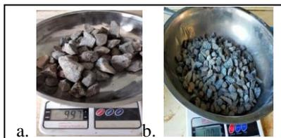
**Gambar 9.** Hasil Pengujian Kadar Lumpur Agregat Kasar (a. Beton Normal, b. Limbah Beton)
