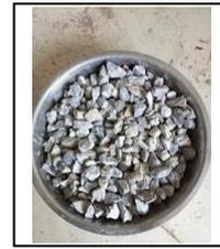
**Gambar 3.** Agregat Kasar Limbah Beton
