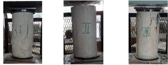
**Gambar 12.** Hasil Pengujian Kuat Tekan Beton Normal
