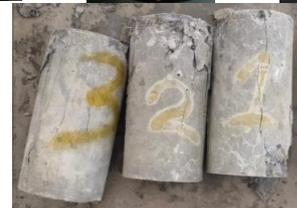
**Gambar 13.** Hasil Pengujian Kuat Tekan Limbah Beton.
