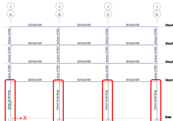
Gambar 23. Konfigurasi kolom yang diperkuat steel jacketing
