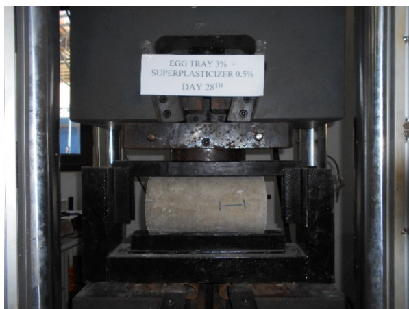
Gambar 3. Pengujian kuat tarik belah beton
