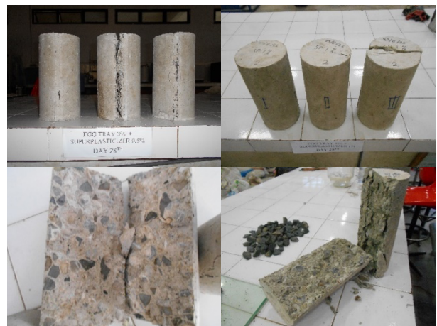
Gambar 5. Pola retak pengujian kuat tarik belah
