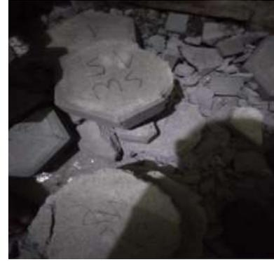
Gambar 9. Sampel Variasi 2% Setelah Uji Kuat Tekan
