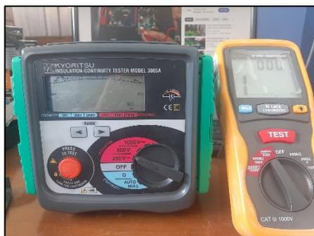
**Gambar 3.** Alat Megger Tester Untuk Uji Ketahanan
