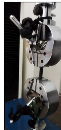
Gambar 2. Alat Tensile Test (Sumber: Dokumentasi Pribadi)
