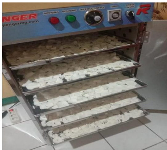
Gambar 5. Proses awal pemasukan bahan ke alat pengering
