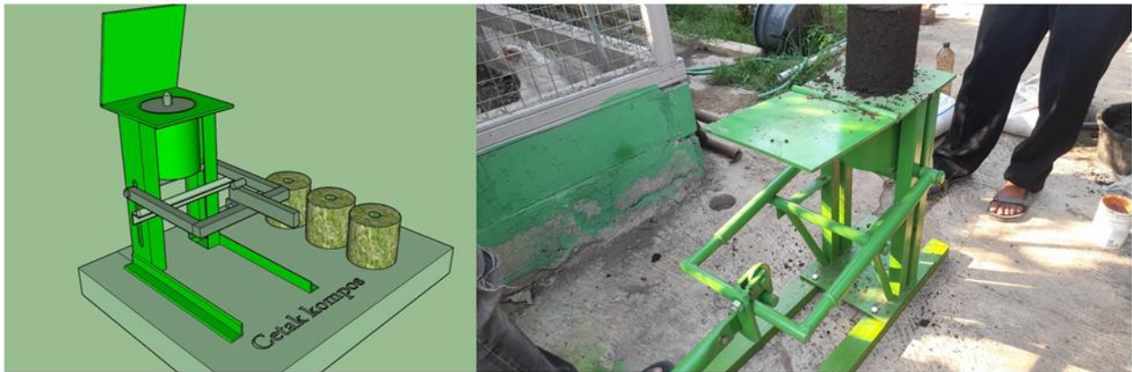
Gambar 2. Gambar desain alat, bentuk alat jadi, dan contoh produk kompos blok.
