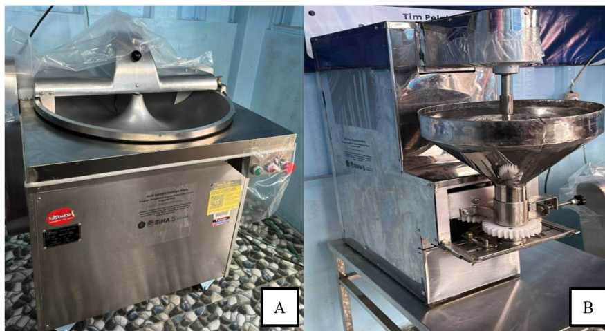
Gambar 2. Teknologi Tepat Guna (TTG) Yang Diberikan Untuk Poklahsar Dadhen Mandiri; (A) Mesin Penggiling ( Bowl cutter ) Mekanis Dan (B) Mesin Pencetak ( Forming ) Adonan Untuk Sempol Dan Tahu Bakso.
