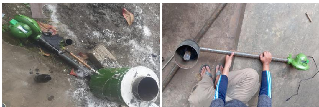
Gambar 1. Kompor Pelebur berbahan bakar Oli Bekas dan Proses Pembuatannya.
