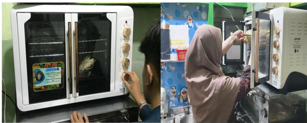
Gambar 6. Proses Pengovenan dan Penirisan Mie Instan menggunakan Oven Listrik 120L.
