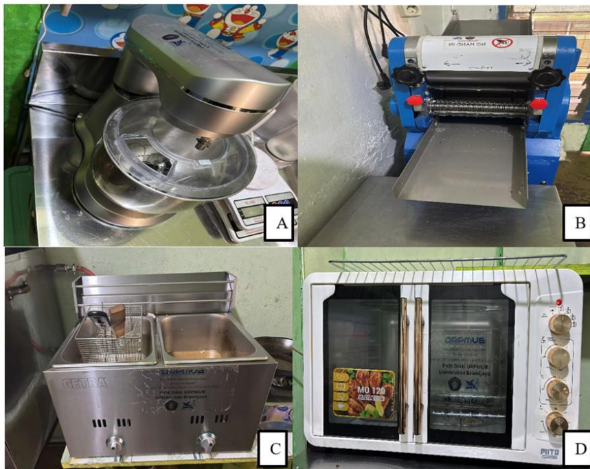
Gambar 2. Teknologi Tepat Guna (TTG) Yang Diberikan Untuk UMKM Dua Putri Tavidia; (A) Stand Mixer , (B) Mesin Pencetak Mie Kapasitas 35 kg, (C) Deep fryer dan (D) Mesin Oven Listrik kapasitas 120 L.
