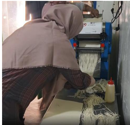
Gambar 4. Proses Pencetakan Adonan Mie menggunakan Mesin Pencetak Mie kapasitas 35 kg.
