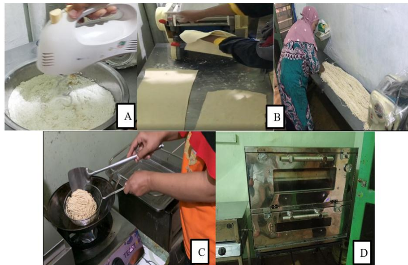
Gambar 1. Proses Pembuatan Mie Instan Patin UMKM Dua Putri Tavida; (A) Pengadonan Dengan Hand Mixer, (B) Pencetakan Mie Menggunakan Mesin Pencetak Mie Kapasitas 5kg, (C) Proses Penggorengan Mie Kering Menggunakan Wajan dan (D) Pemanggangan Mie menggunakan Oven Gas.
