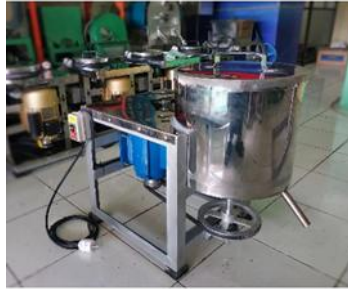
Gambar 11. Mesin Peniris ( Spinner ) Minyak Kapastias 5 Kg.
