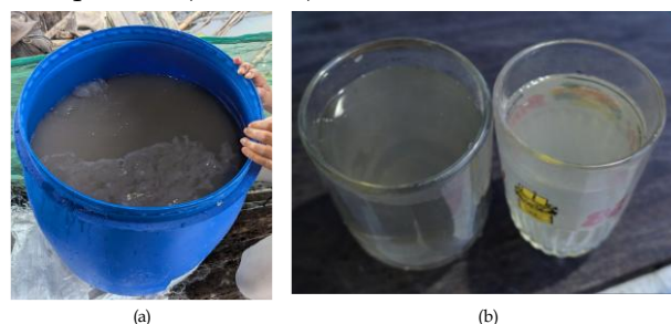
Gambar 1. Visualisasi air rawa (a) sebelum difilter dan (b) sesudah difilter (gelas sebelah kiri sesudah beberapa kali penyaringan ulang).
