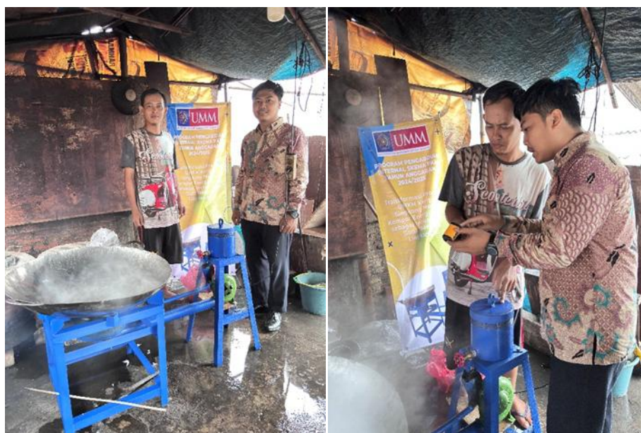
Gambar 3. Penggunaan thermogun dalam pemantauan temperatur minyak penggorengan.
