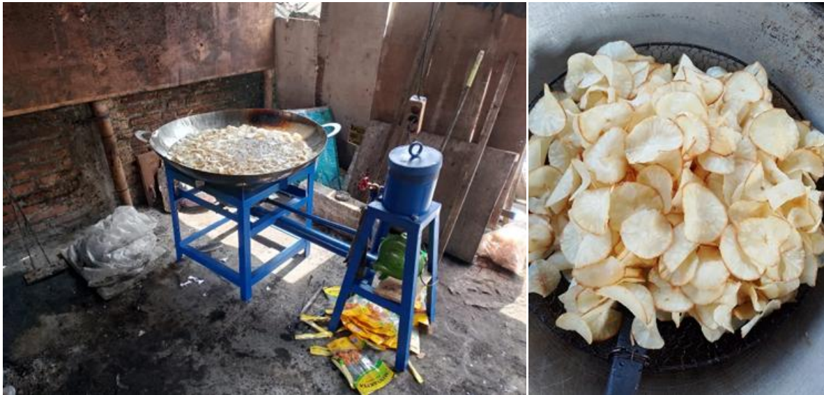
Gambar 4. Penggorengan keripik singkong menggunakan kompor oli bekas dan produk keripik singkong yang dihasilkan dengan alat baru sesuai SOP.
