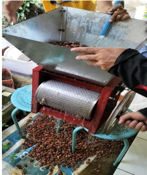
Gambar 3. Proses melepaskan kulit biji kopi
