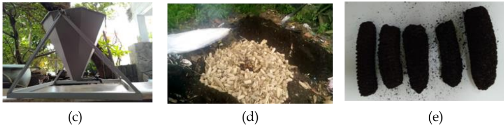
Gambar 2. Dua metode pembakaran tongkol jagung menjadi biochar. (c) alat pembakar Kon-Tiki; (d) pembakaran langsung pada lahan; (e) hasil biochar tongkol jagung.
