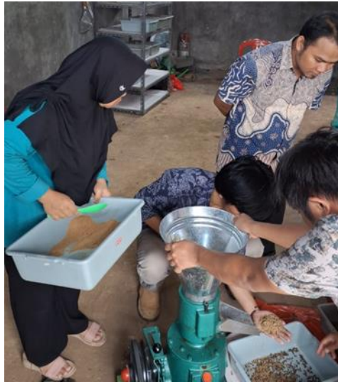
Gambar 4. Proses pemasukan bahan pakan ikan ke alat cetak pelet.
