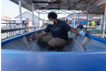
Finishing Polyurethane Pada Rangka Kapal
