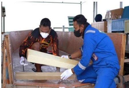
Pemasangan Polyurethane Pada Rangka Kapal
