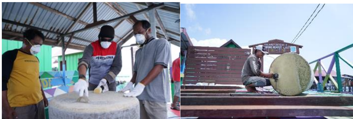
Gambar 3. Pelatihan pemanfaatan polyurethane foam sebagai pelampung.
