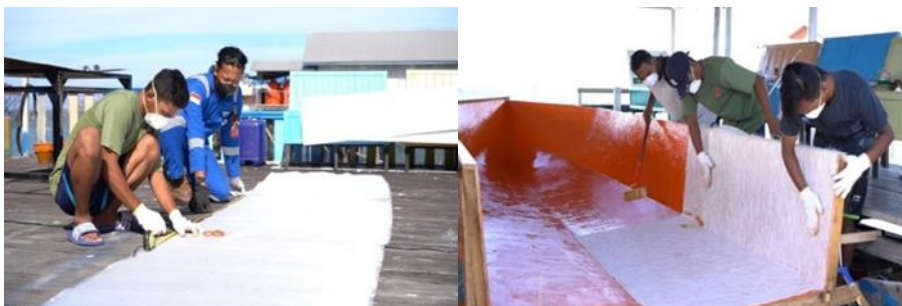
Gambar 2. Pelatihan pemanfaatan polyurethane foam (PUF) membuat kapal nelayan.
