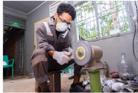
Pembentukan Baling-Baling sesuai ukuran
