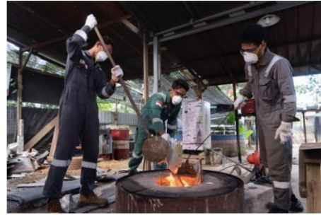
Proses pemanasan dan peleburan di tungku
