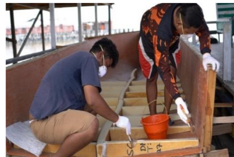
Pemasangan Polyurethane Pada Rangka Kapal
