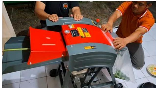
**Gambar 2.** Uji Coba Mesin Pencacah.
