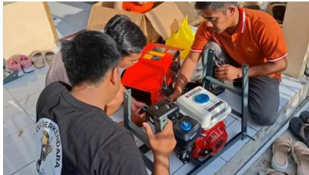
**Gambar 1** Proses Perakitan Mesin Pencacah.
