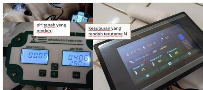
Gambar 4. Hasil pengukuran kesuburan tanah menggunakan sensor yang terhubung ke internet.
