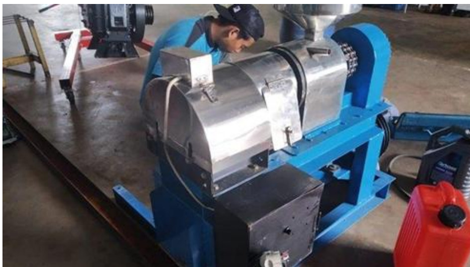
Gambar 10. Mesin Pembuat Pakan Ikan.
